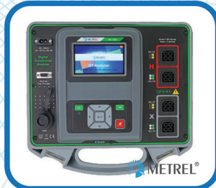
Λόγος μετασχηματισμού & αντίσταση τυλιγμάτων Μ/Σ
