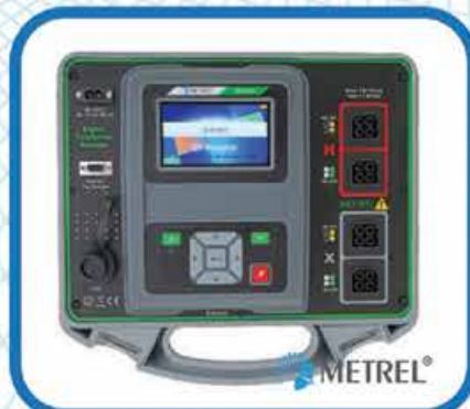
Λόγος μετασχηματισμού & αντίσταση τυλιγμάτων Μ/Σ
